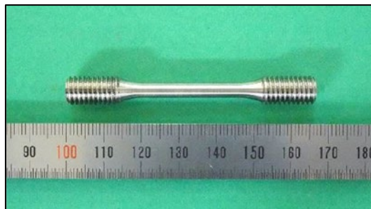
図 3.2.1(3)⑤-1 引張試験片外観例
